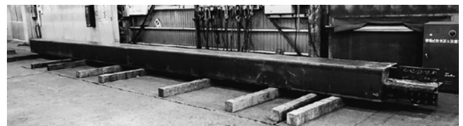
写真3 モックアップ試験体
